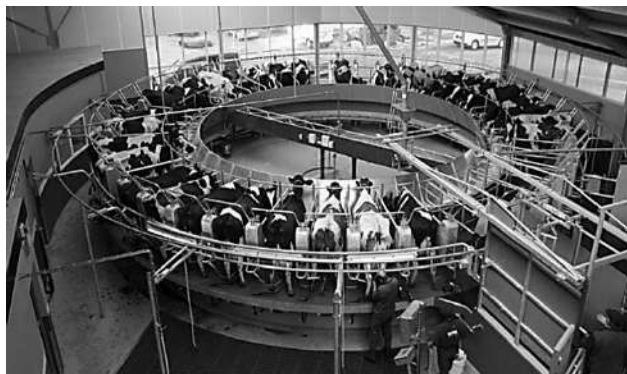
Рис. 1. Доильная установка УДА-100 «Карусель»
