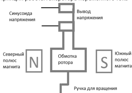
Рисунок 1 — Устройство генератора переменного тока
