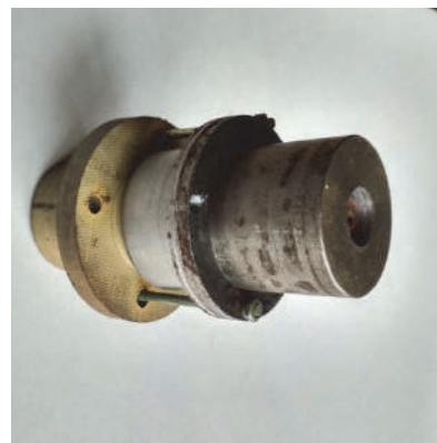
Рисунок 1 — Внешний вид разработанного плазматрона
