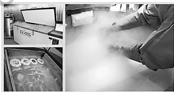
Рисунок 1 — Оборудование для криогенной обработки и процесс обработки
