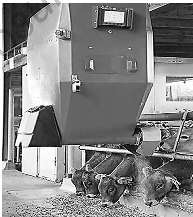
Рисунок 1. — Робот-кормораздатчик Pellon Combi
