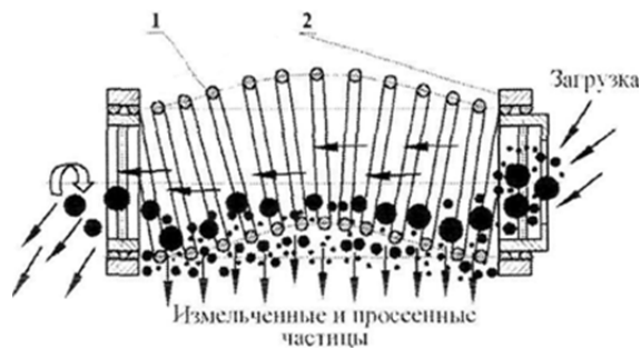
Рисунок 4 — Принцип работы пружинной мельницы
