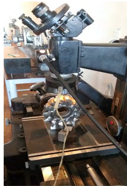
Рисунок 2. – Общий вид измерительного устройства на базе микроскопа УИМ-21
