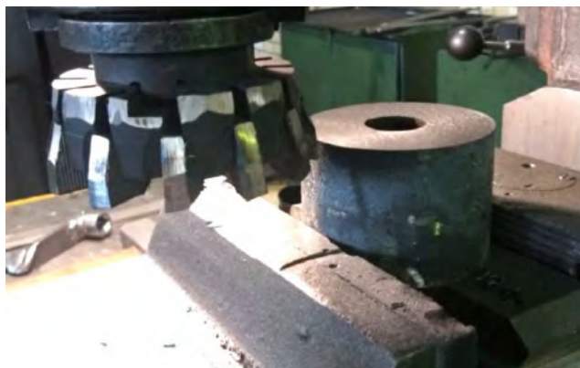
Рисунок 1. – Фреза торцовая Ø 125 мм ГОСТ 24359-80 с 12 ножами 2021-0015 ВК8
