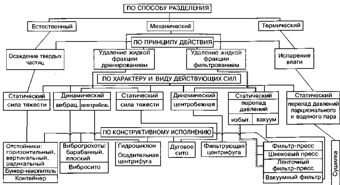
Рисунок 1 — Способы разделения жидкого навоза [1]
