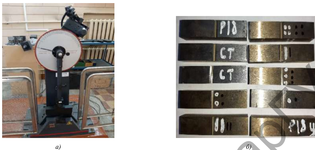
Рисунок 1 — Общий вид маятникового копра модели TIMEJB-300B (а), исследуемых образцов (б)
