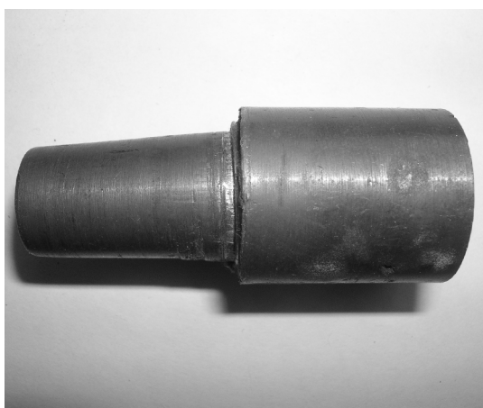
Рисунок 4 — ЭКС, восстановленный разработанными сплавами
