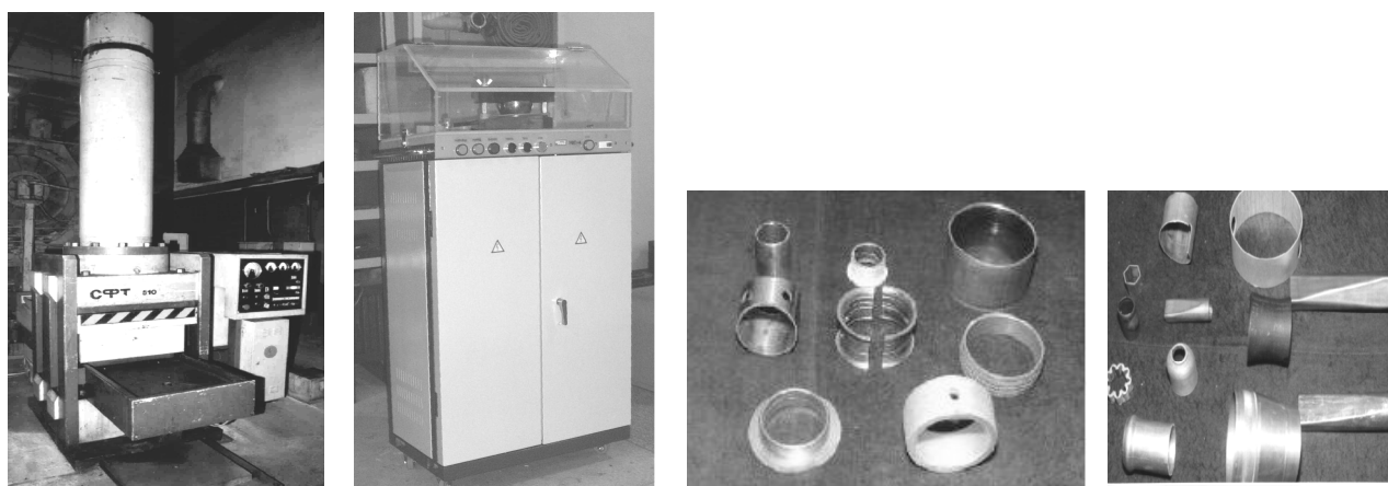
Рисунок 1 — Прессы импульсной листовой штамповки (а), магнитно-импульсной штамповки (б), образцы деталей (в и г)
