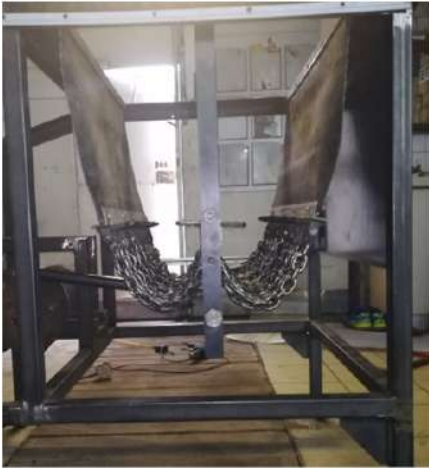
Рисунок 2 — Цепной агрегат с двухволновой рабочей камерой и верхним подвесом маятниковых рычагов (вид сбоку) [2]
