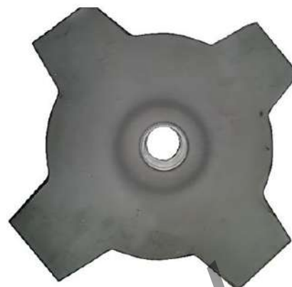
Рисунок 4 — Общий вид 4-х лопастного ножа для мотокосы после ИПА
