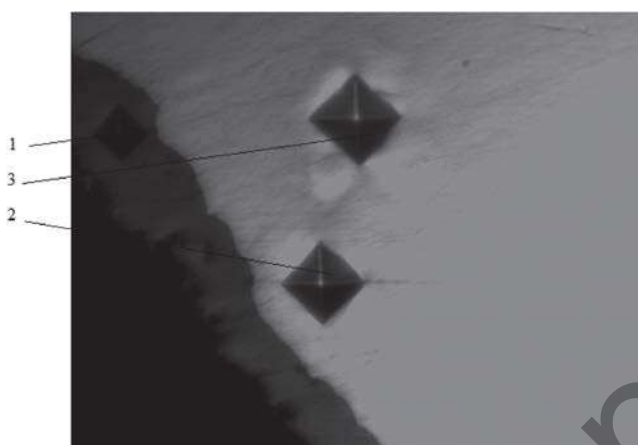
Рисунок 2 — Вид упрочненного слоя на образце из стали 40Х
