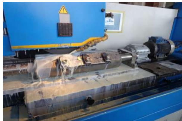
Рисунок 5. — Фотография устройства для заточки геликоидальных рубильных ножей, укомплектованного электродвигателем
