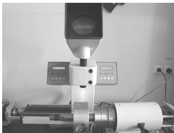
Рисунок 4. — Измерение угла наклона кромки на установке OptiControl
