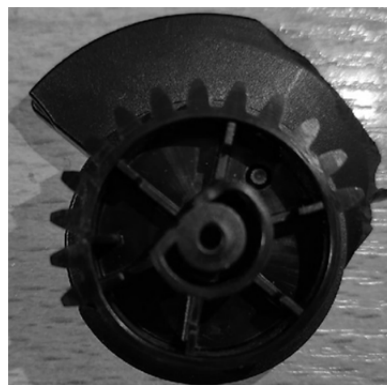
Рисунок 2 — Шестерня, вышедшая из строя
