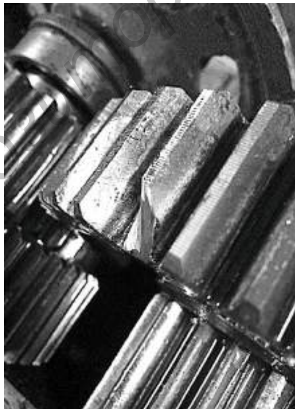
Рисунок 2. — Общий вид исследуемой шестерни с локальным дефектом в виде скола зуба
