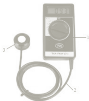
Рисунок 2 — Внешний вид люксметра «ТКА-ПКМ» (31)
