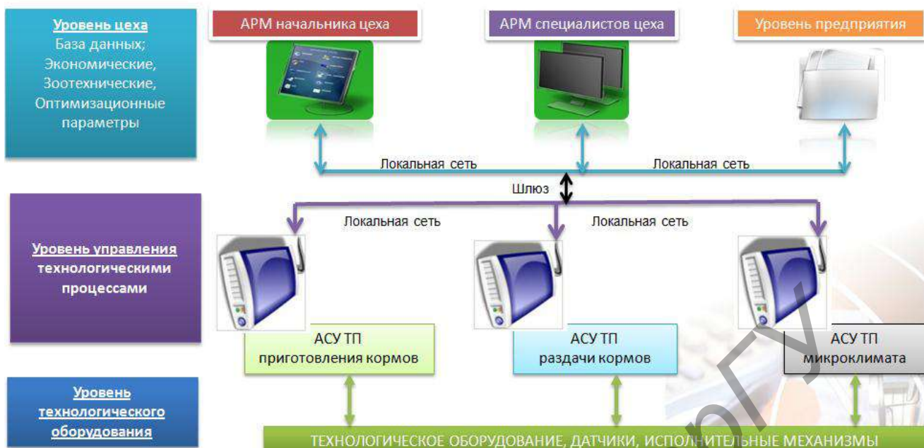
Рисунок 1. – Базовые принципы интегрированных систем управления в животноводстве и свиноводстве
