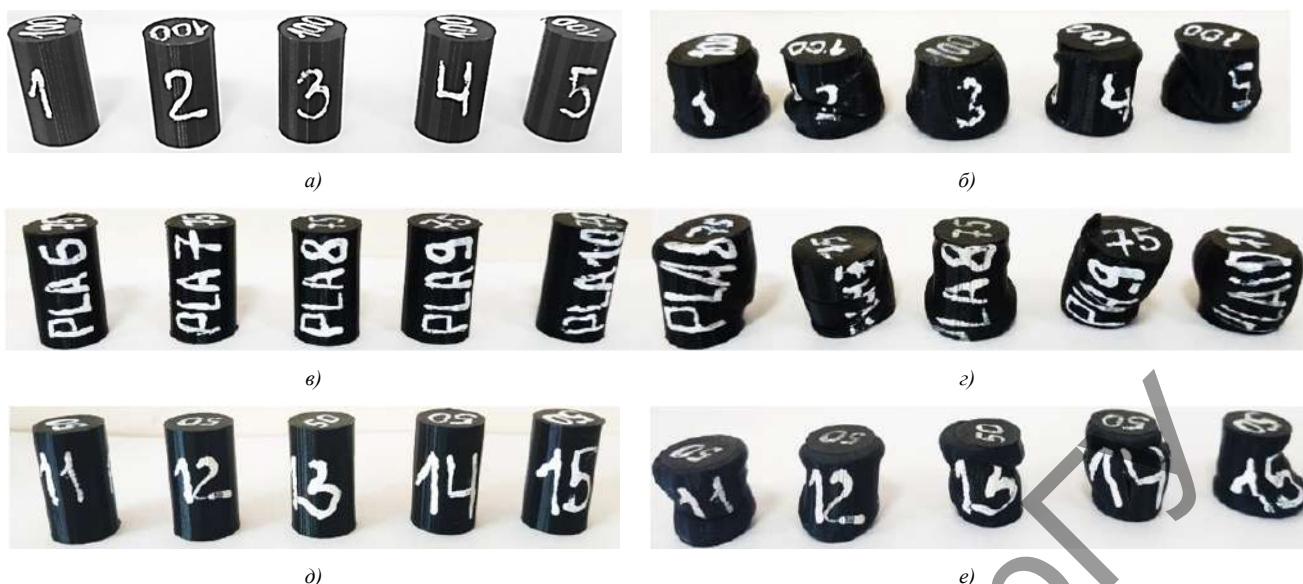
Рисунок 1 — Форма образцов: а — образцы до испытания заполнение 100 %; б — образцы после испытания заполнение 100 %; в — образцы до испытания заполнение 75 %; г — образцы после испытания заполнение 75 %; д — образцы до испытания заполнение 50 %; е — образцы после испытания заполнение 50 %
