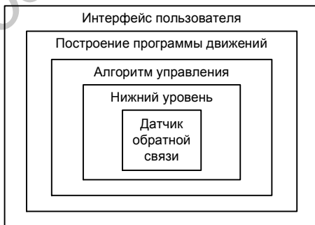
Рисунок 1 — Иерархическая структура системы управления многокоординатной системой перемещений
