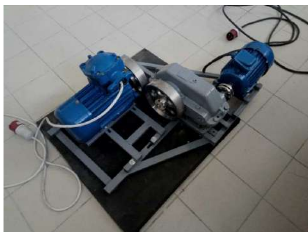
Рисунок 1 – Лабораторная установка вибровалкового измельчителя
