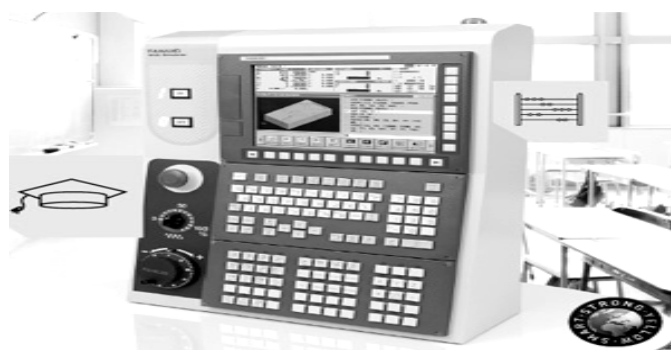
Рисунок 1 — Обучающий стенд ЧПУ Fanuc
