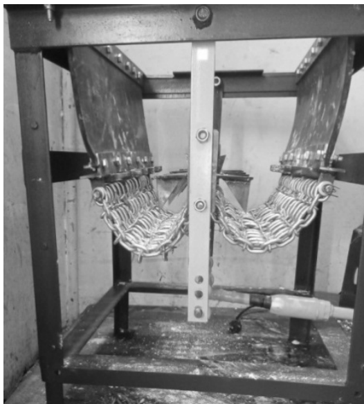
Рисунок 2. — Общий вид экспериментального цепного агрегата с волновой рабочей камерой
