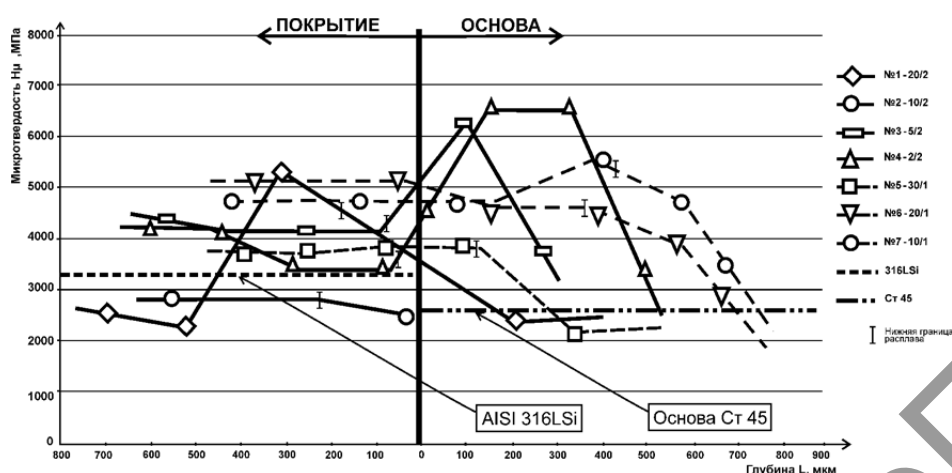
Рисунок 3. — Изменение микротвердости по глубине лазерного воздействия в аргоне (покрытие — AISI 316LSi, основа — Ст 45)
