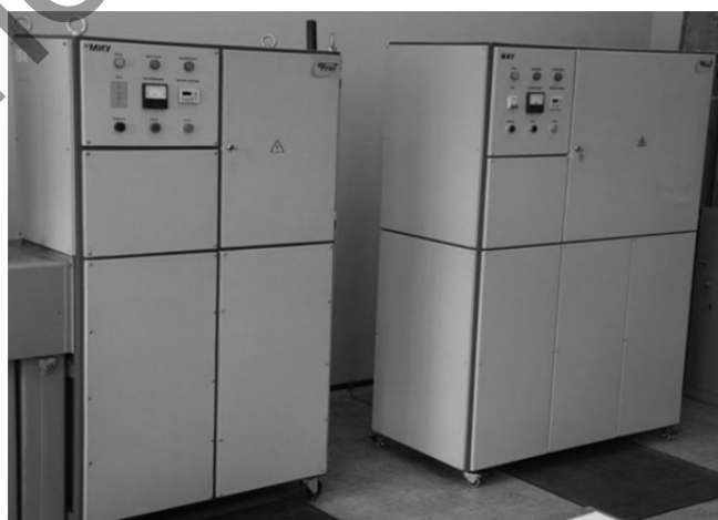
Рисунок 2. — Магнитно-импульсные установки с различными техническими характеристиками для обеспечения упрочняющего воздействия на стальные изделия
