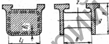
Рисунок 3.4 — Схемы для расчета станины на кручение
