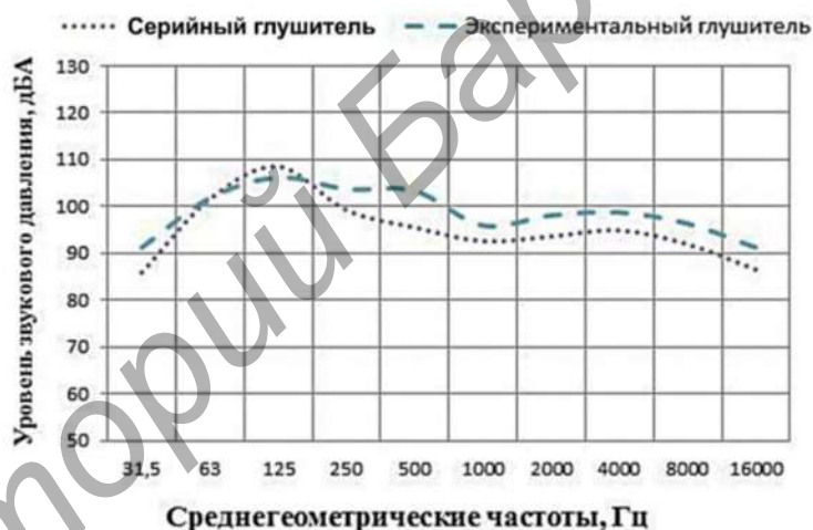
Рисунок 3. Уровень звукового давления на срезе глушителей на режиме максимальных оборотов двигателя
