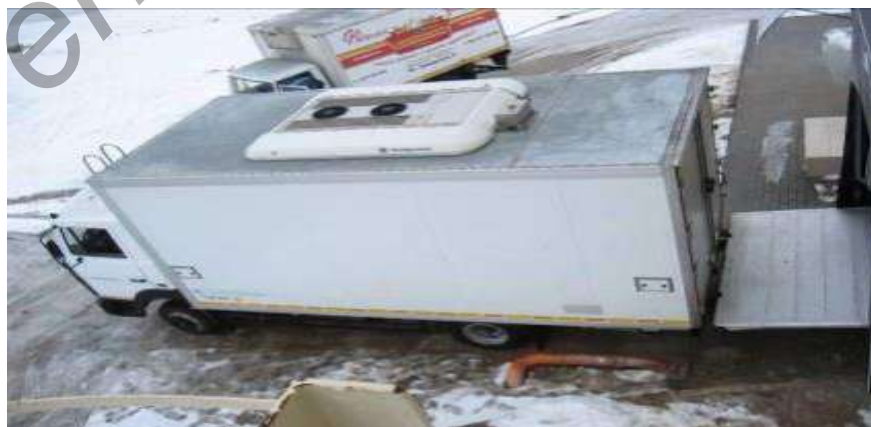
Рис. 1. Подача под загрузку транспортного средства с термоизолированным кузовом
