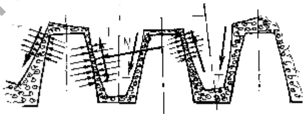
Рисунок 8.4 — Кластерная смазка между зубьями червячного колеса и витками червяка
