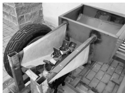
Рисунок 3 — Двухрядная роторно-ложечная картофелесажалка
