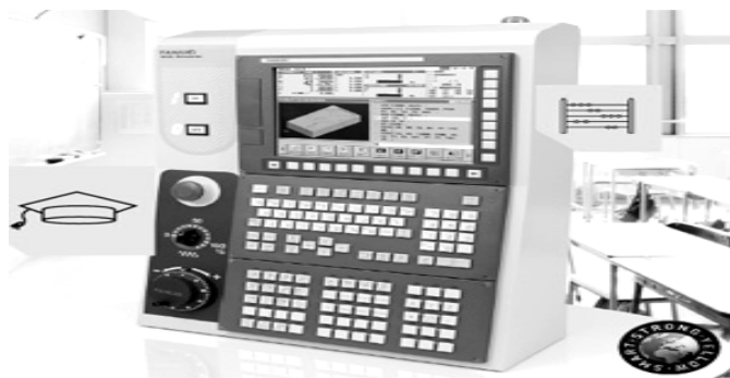
Рисунок 1 — Обучающий стенд ЧПУ Fanuc
