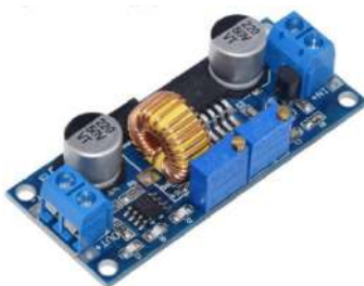
Рисунок 5 — Понижающий преобразователь DC-DC на XL4015
