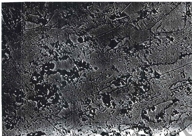
Рисунок 6. — Непротравленная микроструктура доуплотнённых образцов. \times 50
