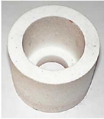
Рисунок 1 — Экспериментальный шлифовальный круг 6 60×50×25
