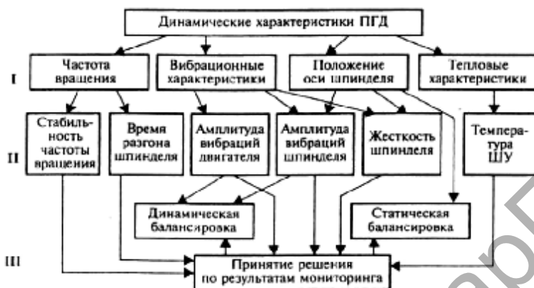
Рисунок 7.2 — Схема мониторинга ПГД по динамическим характеристикам
