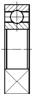
Рисунок 3 — Изображение подшипника в разрезе или сечении
