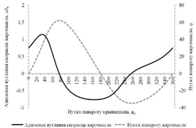
Рысунк 8 – Графік змянення адноснай вуглавой скорасці каромысла \omega_h^\xi у залежнасці ад вугла павароту крывашыпа \varphi_k (пры \rho = 0,5 )
