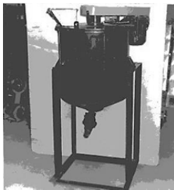
Мельница планетарная для жидкотекучих материалов (соответствует схеме 6 таблицы 5.1 главы 5)
