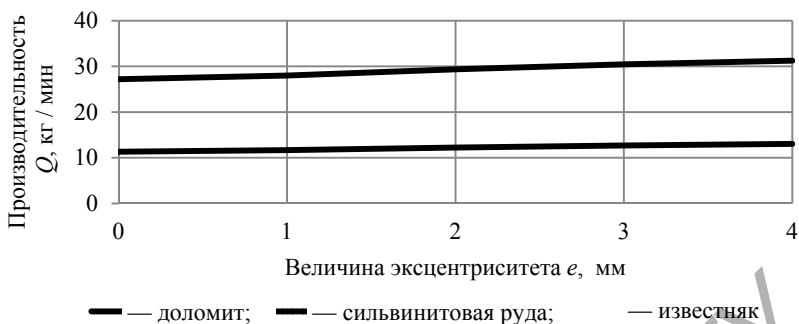
Рисунок 4.23 — Зависимость влияния величины эксцентриситета e на производительность Q
