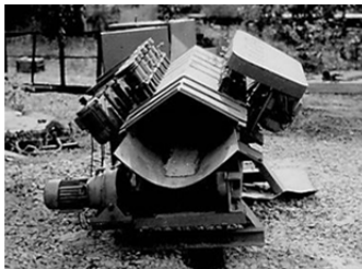
Многоцелевой смеситель-активатор непрерывного действия (соответствует схеме 13, 15 таблицы 5.2 главы 5)
