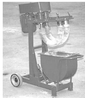
Мельница для приготовления цементных коллоидных клеев (соответствует схеме 2 таблицы 5.1 главы 5)
