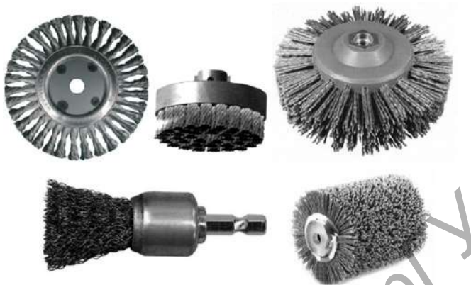
Рисунок 7.3 — Разновидности иглофрезерных элементов
