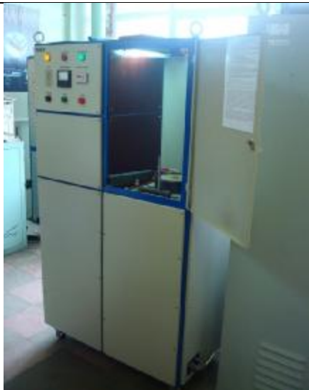
Рис. 2. Магнитно-импульсная установка для упрочняющей обработки дереворежущих ножей
