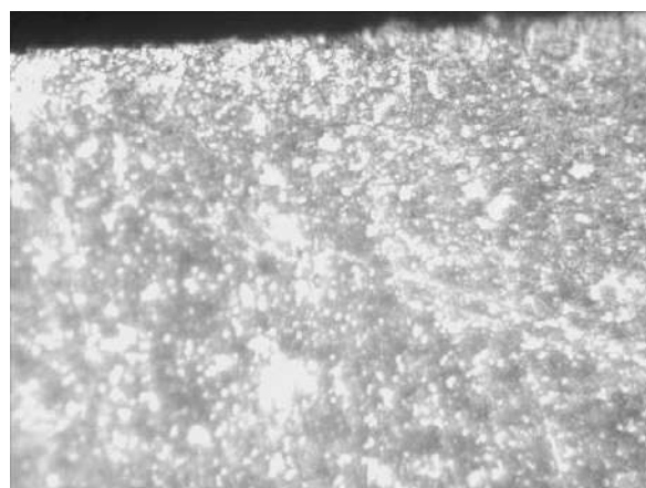
Рисунок 2. — Микроструктура образца стали Р6М5 после МИО по режиму I. × 400 (а); ×1 000 (б)
