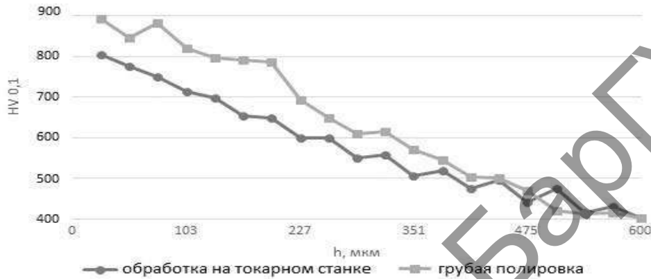
Рис. 2. Твердость и глубина азотируемого слоя стали 3Х2В8Ф в зависимости от вида обработки
