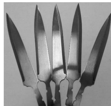
Рисунок 1. — Заготовки ножа универсального НУС-1 (ОАО «Красный металлист»)
