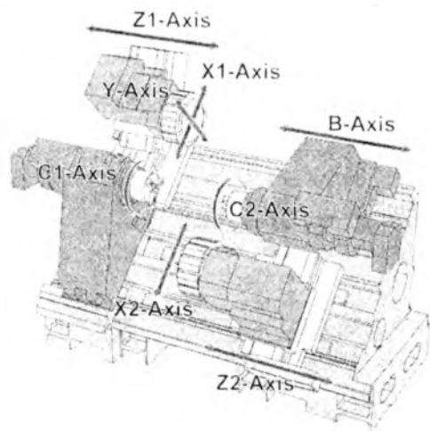
Рисунок 3 — Положение осей у токарного станка с контршпинделем и двумя револьверными головками ( www.domss.doosaninfracore.com )
