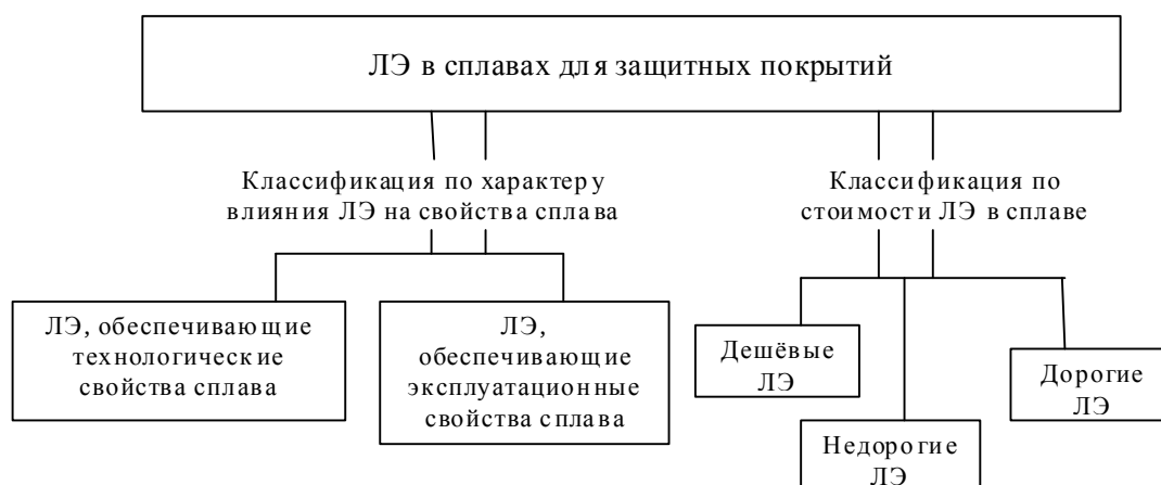
Рисунок 1 — Классификация ЛЭ в наплавочных сплавах для ЗП
