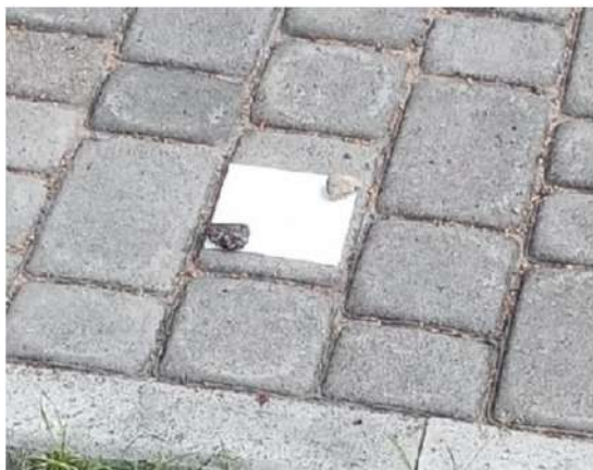
Рисунок 3 — Отбор проб при помощи фильтровальной бумаги
