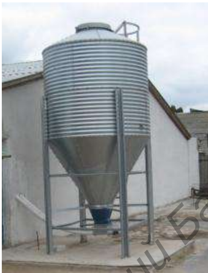
Рисунок 2 – Вид на бункер для сыпучих кормов БСК-15
