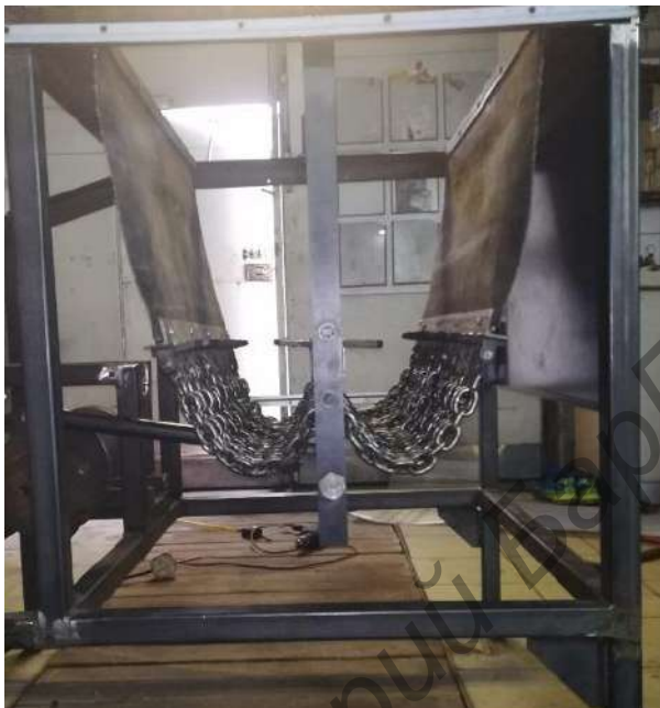
Рис. 4. Цепной агрегат с двухволновой рабочей камерой и верхним подвесом маятниковых рычагов
