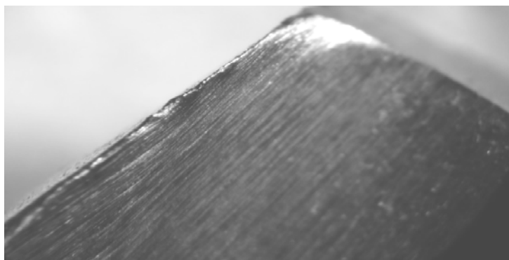
Рисунок 3 — Сколы на главной режущей кромке
