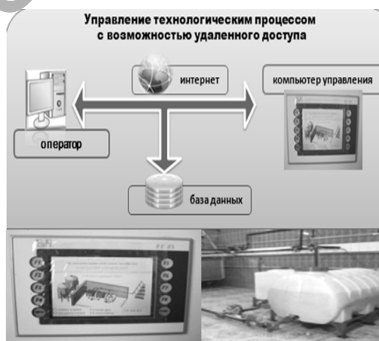
Рисунок 1 — Адаптивная система автоматического кормления свиней
