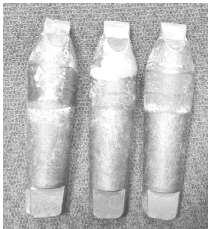
Рисунок 1 — Внешний вид резцов Д6-22М
