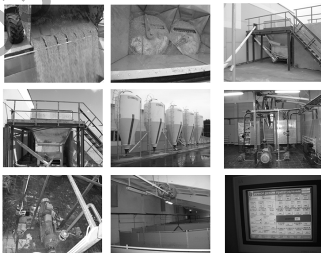
Рисунок 3 — Комплект оборудования для приготовления кормовой добавки на основе консервированного влажного зерна кукурузы КОДК
