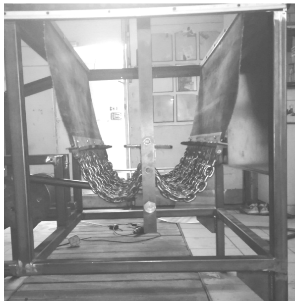
Рисунок 2 — Цепной агрегат с двухволновой рабочей камерой и верхним подвесом маятниковых рычагов (вид сбоку)
