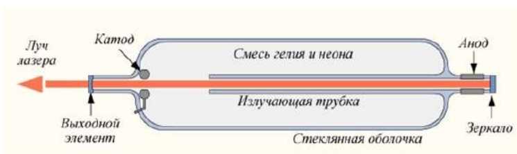
Рисунок 1 — Принцип действия газового лазера
