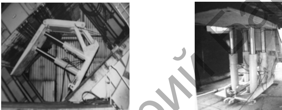
Рисунок 2 — Секция крепи КМ на испытательных стендах
