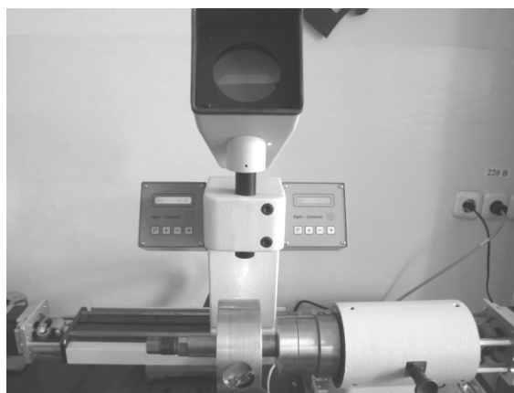
Рисунок 4. — Измерение угла наклона кромки на установке OptiControl
