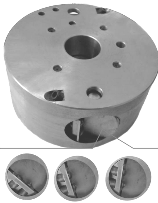
Рисунок 1. — Фреза сборная с изменяемыми углами передним и наклона кромки
