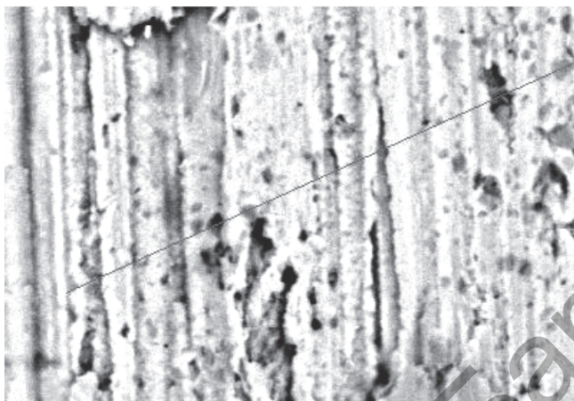
Рисунок 4.29 — Топография поверхности покрытия из материала марки ПГ-СР4 после обработки МЭШ
